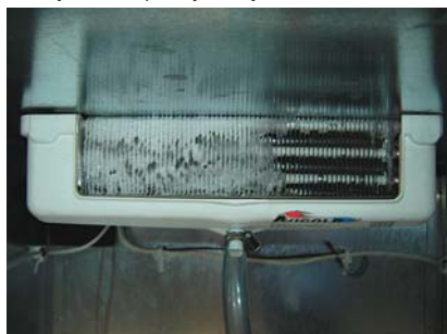
Rys. 5. Oszronienie chłodnicy w konfiguracji tradycyjnej (praca z termostatem)
