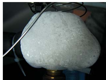
Rys. 11. Lód na zaworze z polaryzatorom
