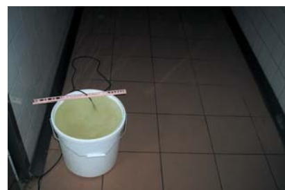
Rys. 15. Układ do rejestracji zmian temperatury zamrażanej wody
