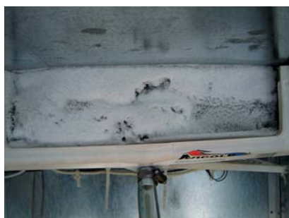
Rys. 8. Oszronienie chłodnicy w układzie z polaryzatorami (praca ciągła)
