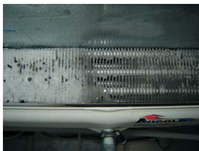
Rys. 6. Oszronienie chłodnicy w układzie z polaryzatorami (praca z termostatem)
