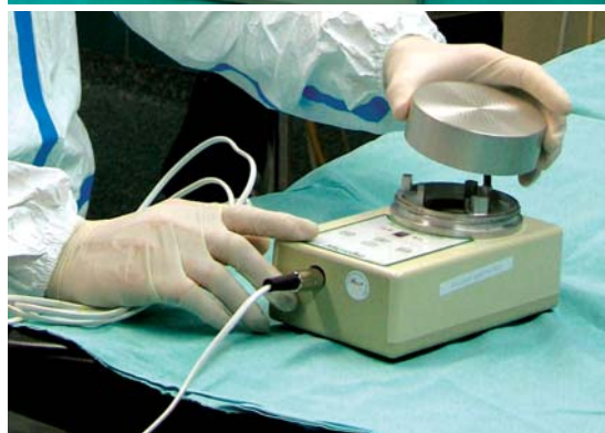
Rys.8 Umieszczenie płytki z podłożem w aparacie i jej wyjęcie może powodować zanieczyszczenie wprowadzające błąd porównywalny z wielkością mierzoną [5]
