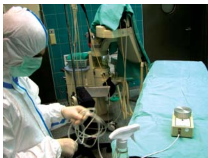
Rys.6 Pomimo kompletnego, sterylnego ubioru ochronnego i niezwyklej dbałości podczas wykonywania pomiarów dochodzi do zanieczyszczenia podłoża wzrostowego, co w efekcie daje wynik o kilka JTK/m 3 większy od rzeczywistego stężenia zanieczyszczeń. Zdalnie uruchamiany miernik umożliwia zminimalizowanie wpływu eksperymentatora na wynik pomiaru [5]
