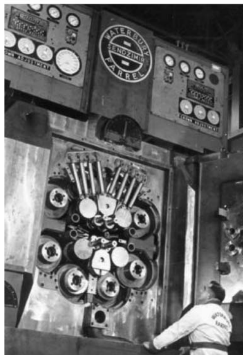
Rys.2. Walcarka Sendzimira ZR 21-55 z połowy lat 60. XX w. [7]
