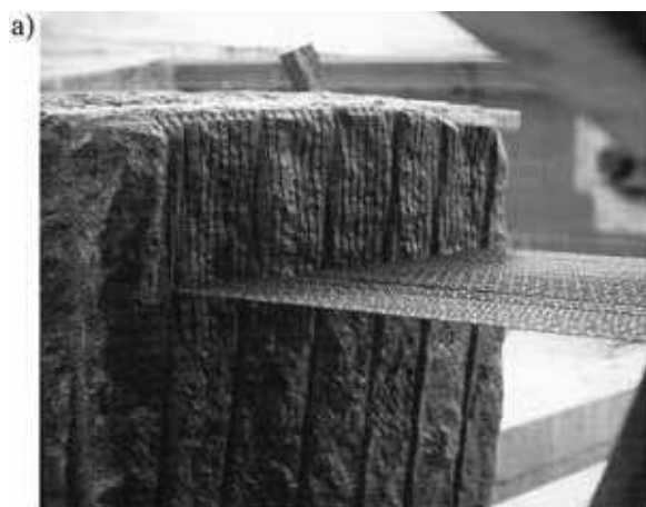
Rys. 6. Przykłady zastosowania pił linowych: a) cięcie bloku skalnego na płyty [2], b) cięcie ścian budynku podczas rozbudowy [25]
