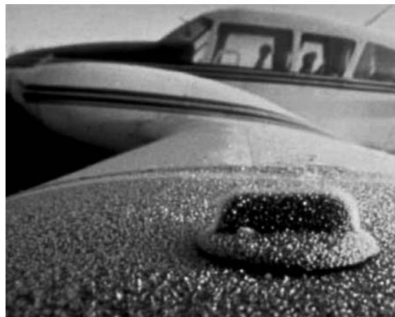
Rys. 7. Skrzydło samolotu pokryte szadzią [9]
